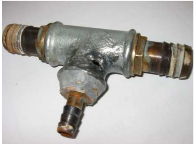
trotz Abdichtung mit Knetmetall durchkorrodiert
